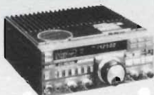
YAESU FT 757 GX II Ricetrasmittitore HF, FM, AM, SSB, CW, trasmissione e ricezione continua da 1,6 a 30 MHz; ricezione 0,1-30 MHz; potenza RF-200 W P e P in SSB, CW, scheda FM optional.
