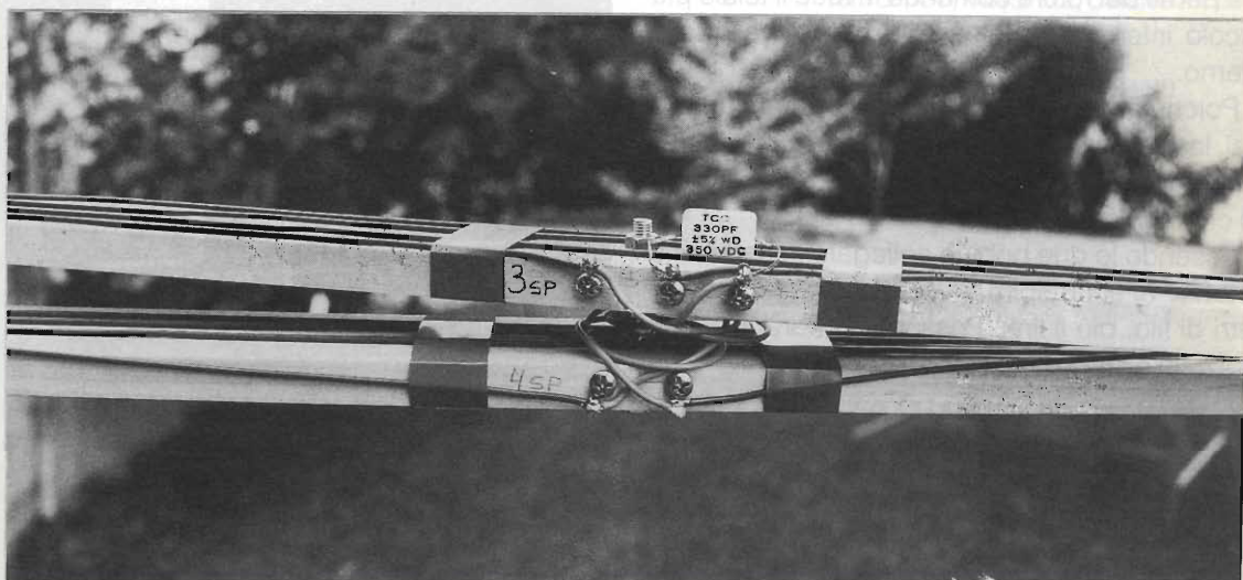
foto 2 - Particolare della giunzione superiore, con le pagliette di ancoraggio, il condensatore ed il collegamento lasco per la rotazione.
