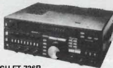
YAESU FT 736R Ricetrasmittitore base All-mode bibanda VHF/UHF. Modi d'emissione: FM/USB/LSB/CW duplex e semiduplex. Potenza regolabile 2,5 - 60 W (opzionali moduli TX 50 MHz 220 MHz 1296 MHz). Alimentazione 220V. 100 memorie, scanner, steps a piacere Shift \pm 600 \pm 1600 .
